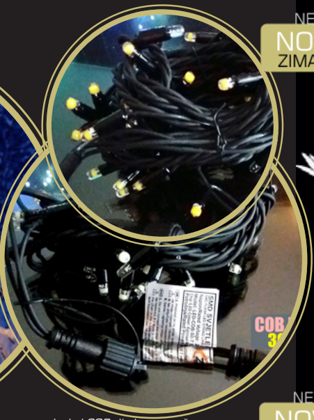
Izgled COB dioda na ugašenom LED 'kanapu'. Čip je vidno dominantan.
